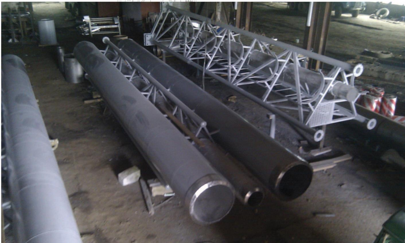
рис. 8. Секции вытяжных башен.
