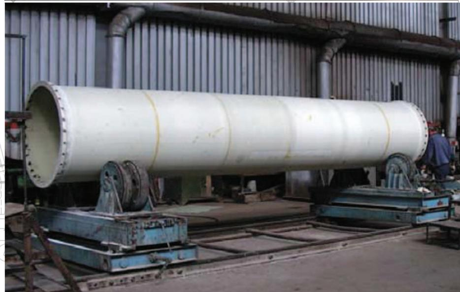
рис.10. Газоотводящие стволы Т-КМ2 из стеклопластика.
