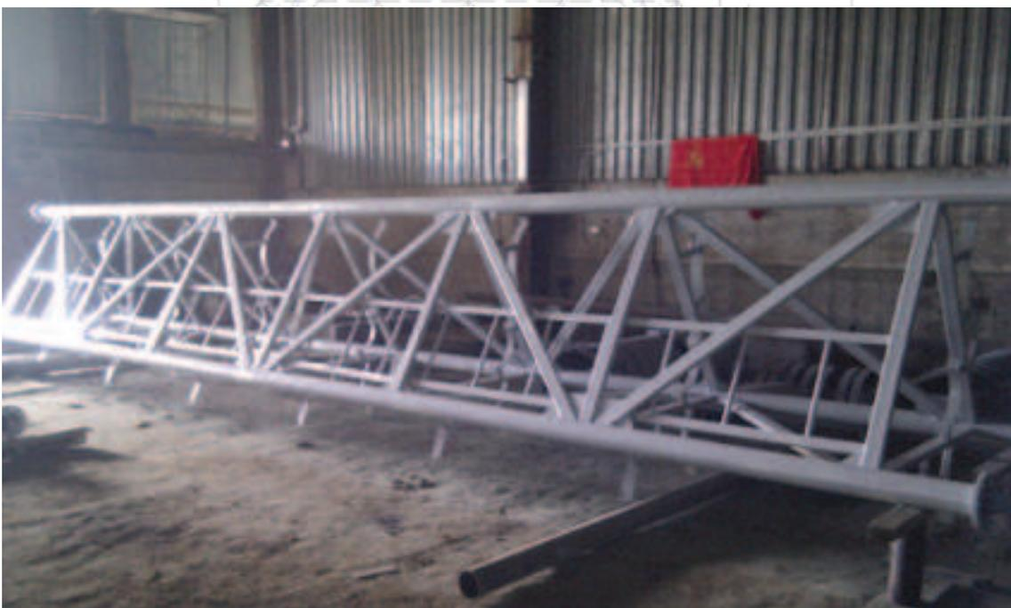
рис.7. Секция решетчатой башни.
